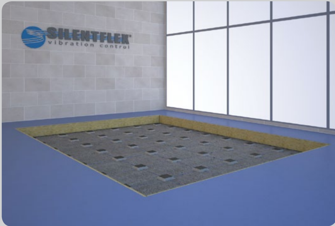
Sobre el foso se posicionan los apoyos nivelados (opcional) y se cubre el perímetro con lana de roca
